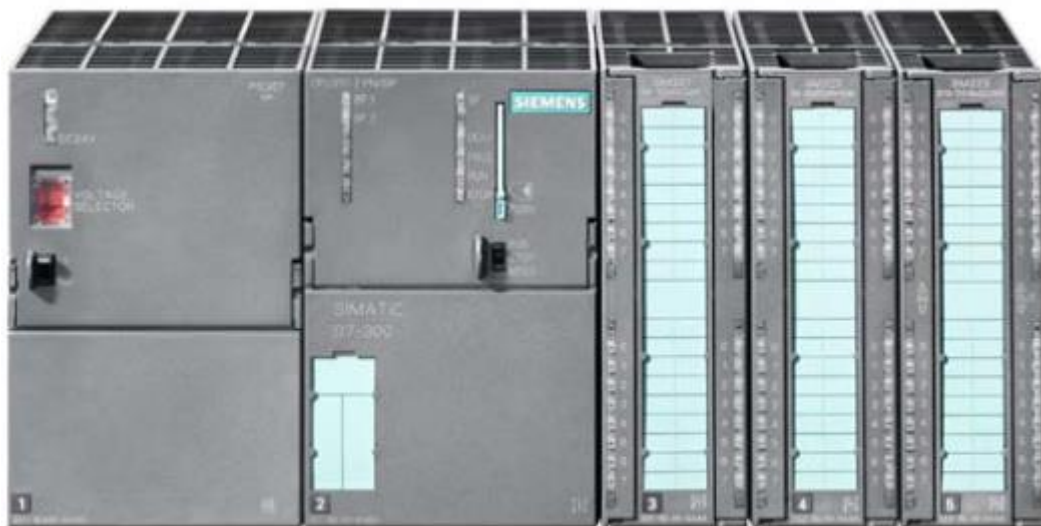
Station S7-300 composée d'un CPU 317-2PN/DP, d'un module d'alimentation et de 3 modules de signaux SM
