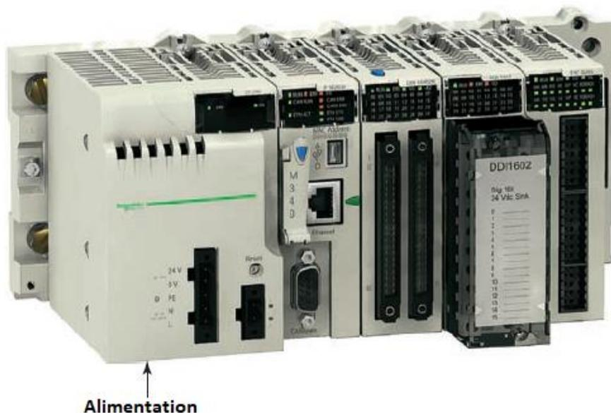
Quand un module est glissé dans le rack, il établit une connexion électrique avec une série de contacts appelé fond de panier, situé à l'arrière du rack.
